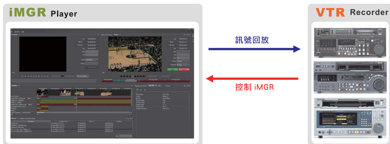
圖：iMGR 可以切換成 Player，做影片的回放，並可讓 VTR 控制找點
